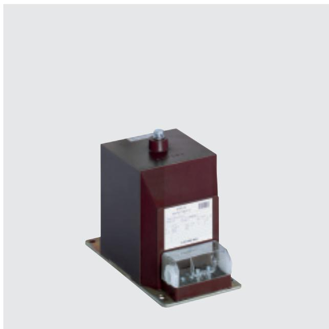
Los transformadores de tensión contienen un solo núcleo magnético, y normalmente están diseñados con un arrollamiento secundario tan sólo. En caso necesario, los transformadores de tensión puestos a tierra (monofásicos) disponen de un arrollamiento de tensión residual adicional aparte del arrollamiento secundario (arrollamiento de medida).
