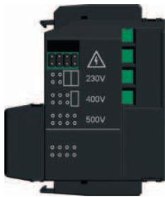
La tensión asignada de empleo específica de la bobina de emisión se fija mediante unos puentes ubicados a la derecha del disparador. El valor prefijado por defecto es siempre el valor máximo.
