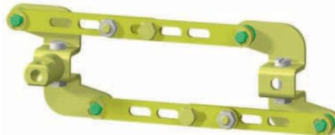
Los módulos de enclavamiento mecánico para la conexión en paralelo se utilizan para la conmutación simultánea de dos interruptores automáticos. Es posible conectar en paralelo dos interruptores automáticos 3VT1. Cada interruptor automático debe dotarse de una unidad de accionamiento manual, y al menos uno de ellos con una maneta (ver pág. 2/25). Para poder llevar a cabo la conexión en paralelo, es absolutamente necesario respetar las dimensiones mostradas en la figura y expresadas en la tabla.
