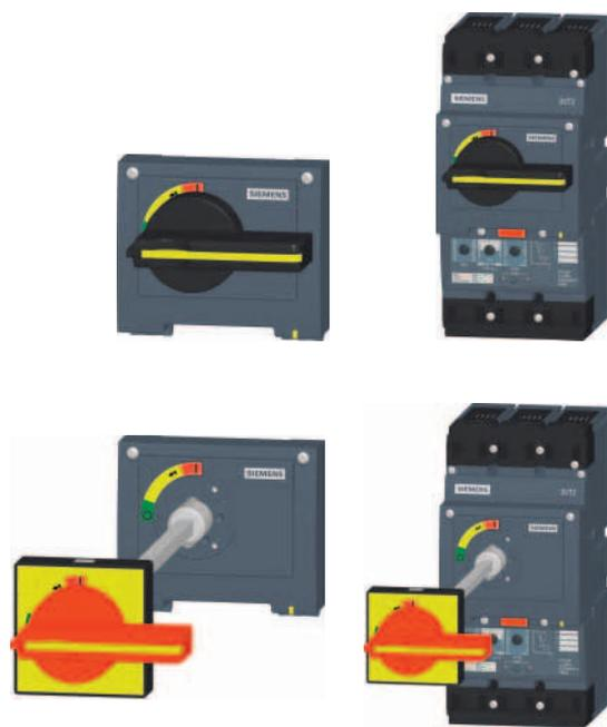
El accionamiento giratorio permite gobernar el interruptor automático mediante una muletilla giratoria, p. ej. para conectar y desconectar máquinas. El diseño modular de los accionamientos facilita su montaje en la unidad de conmutación (también de forma adicional) tras retirar la cubierta del compartimento de accesorios. Es posible sellar un motor fijo. Deberá solicitar el accionamiento y sus accesorios por separado según sus necesidades (ver [pág. 3/6](#)).
