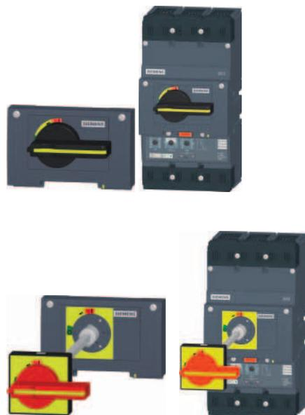
El accionamiento giratorio permite gobernar el interruptor automático mediante una palanca giratoria, p. ej. para conectar y desconectar máquinas. El diseño modular de los mandos facilita su montaje en la unidad de conmutación (también de forma adicional) tras retirar la cubierta del compartimento de accesorios. Es posible sellar un motor fijo. Deberá solicitar el mando y sus accesorios por separado según sus necesidades (ver pág. 4/6).
