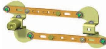
Permite la conmutación simultánea de dos interruptores automáticos o interruptores-seccionadores. La conexión en paralelo puede utilizarse entre dos interruptores automáticos 3VT2 o entre un 3VT2 y un 3VT3. Cada interruptor automático debe dotarse de un accionamiento giratorio, y al menos uno de ellos de una muletilla.
