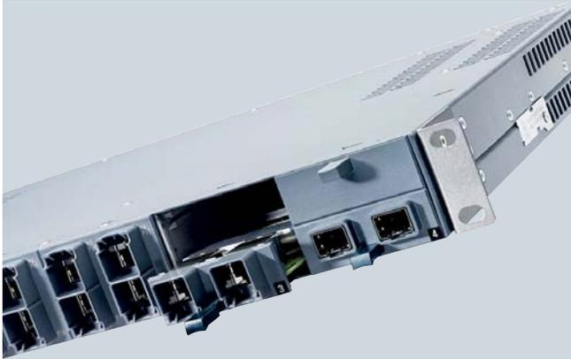
Los switches son componentes de red activos que distribuyen de forma controlada datos a los destinatarios correspondientes. SCALANCE X es la moderna gama de switches de SIMATIC NET para Industrial Ethernet. La gama SCALANCE X se compone de líneas de productos coordinadas entre sí y adaptadas a la correspondiente tarea de automatización.
