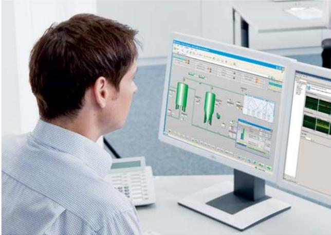
Los PCS 7 Web Clients con Internet Explorer y plug-ins instalables vía Internet acceden vía intranet/Internet a los datos de proyecto facilitados por el SIMATIC PCS 7 Web Server. Los sinópticos del proceso se transforman mediante "Publicación" (Publishing) al formato apropiado para su representación con el Explorador de Internet.
