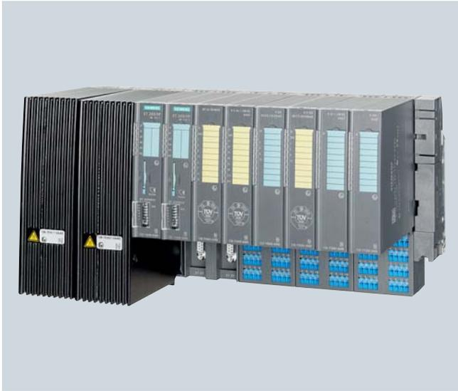
ET 200iSP es un sistema de periferia E/S modular, de seguridad intrínseca y con grado de protección IP30, que puede funcionar en atmósferas de gas y de polvo a una temperatura ambiente de -20 a +70 °C.
