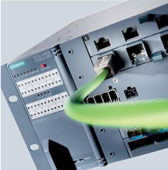
Con los componentes de red SIMATIC NET, basados en los estándares establecidos en todo el mundo, SIMATIC PCS 7 dispone de una potente y resistente gama de productos para instalar redes de comunicación homogéneas para el intercambio seguro de datos entre todos los componentes y niveles de una planta.
