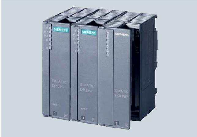
El link Y es un acoplador de bus para la transición de un sistema maestro PROFIBUS DP redundante a un sistema maestro PROFIBUS DP sencillo y monocanal. Puede utilizarse para conectar aparatos con una sola interfaz PROFIBUS DP al sistema maestro redundante PROFIBUS DP AS 412H, AS 414H, AS 416H o AS 417H.
