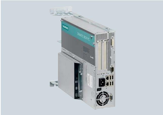
El SIMATIC PCS 7 BOX OS Client 627C se basa en el SIMATIC Box PC de tipo SIMATIC IPC627C y se puede utilizar en el sistema de control de procesos SIMATIC PCS 7 como cliente OS o como cliente SIMATIC BATCH. Para estas aplicaciones constituye una alternativa a los clientes basados en un SIMATIC Microbox PC o un SIMATIC Rack PC.
