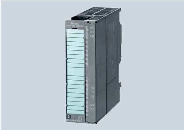
El módulo FM 350-1 es un módulo de contaje inteligente de 1 canal para tareas de contaje simples, apto para la conexión directa de encoders incrementales. Ofrece una función de comparación con 2 valores comparativos prefijables y salidas digitales integradas para la salida de la reacción al alcanzar el valor comparativo.
