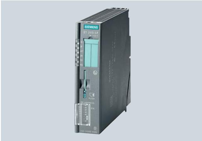
El módulo de interfaz IM 152 realiza la conexión del ET 200iSP a PROFIBUS DP con técnica de transmisión RS 485-iS de seguridad intrínseca para velocidades hasta 1,5 Mbits/s. La conexión también puede ser redundante. En este caso, el ET 200iSP se conecta mediante dos módulos de interfaz a dos líneas PROFIBUS DP de un PLC de alta disponibilidad.
