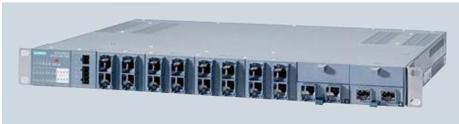
El equipo básico SCALANCE XR-300 en versión PoE es parcialmente modular y está dotado de 16 puertos RJ45 eléctricos integrados (10/100/1000 Mbits/s), ocho de los cuales son compatibles con PoE. Además, dispone de cuatro slots para la ampliación con módulos de medio de 2 puertos (eléctricos u ópticos):
