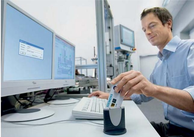
El lector de tarjetas chip permite comprobar la autorización del operador en estaciones individuales o clientes. El lector de tarjetas chip funciona con SIMATIC Logon, la gestión de usuarios con control de acceso integrada en SIMATIC PCS 7 (ver el capítulo "IT Security", sección "SIMATIC Logon").
