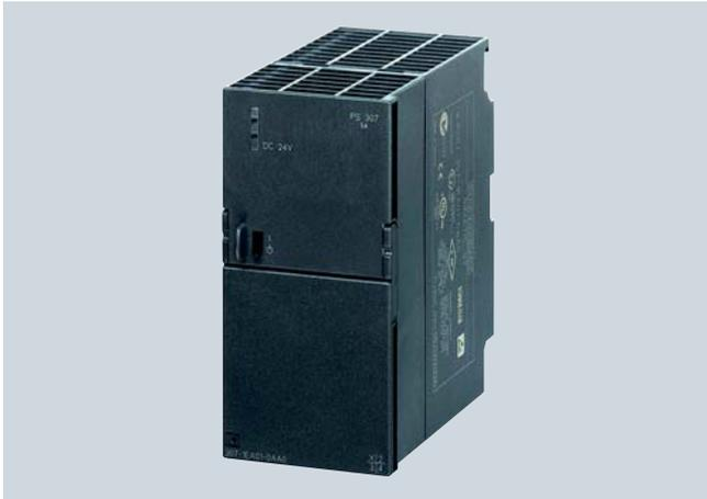
Usted puede usar los alimentadores de corriente de carga PS 307 ó PS 305 como fuente de alimentación para ET 200M. Según el campo de aplicación, usted podrá elegir entre distintas tensiones de entrada e intensidades de salida (120/230 V AC con 2 A, 5 A ó 10 A ó de 24 a 110 V DC con 2 A).
