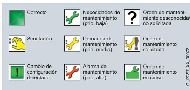
Símbolos unitarios para visualizar el estado de mantenimiento y la conducción del operador
