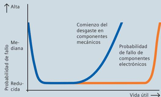
Los módulos electrónicos de acoplamiento tienen una vida útil notablemente mayor que los electromecánicos.
