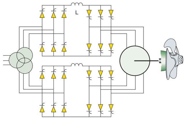
A partir de la descripción de los dos tipos de propulsión, es evidente que la propulsión eléctrica es más compleja que la mecánica, pues requiere de dos equipos para su aplicación (convertidor y motor eléctrico) además de una planta generadora sobredimensionada que por otra parte es necesaria en ambos casos para suministrar la energía eléctrica a bordo.
