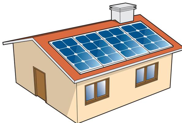
Por el contrario, si la instalación FV altera de modo significativo la forma del edificio, es necesario recalcular la frecuencia de descargas de rayos sobre el mismo y en consecuencia evaluar si es necesario un SPR (Guía CEI 82-25, 2.ª ed.) (figura 6.4).
