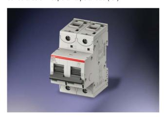
Para los interruptores automáticos de la serie S800S UC, las curvas características disponibles son B y K y ambos tipos poseen corrientes nominales de hasta 125 A y una capacidad de corte de 50 kA.
